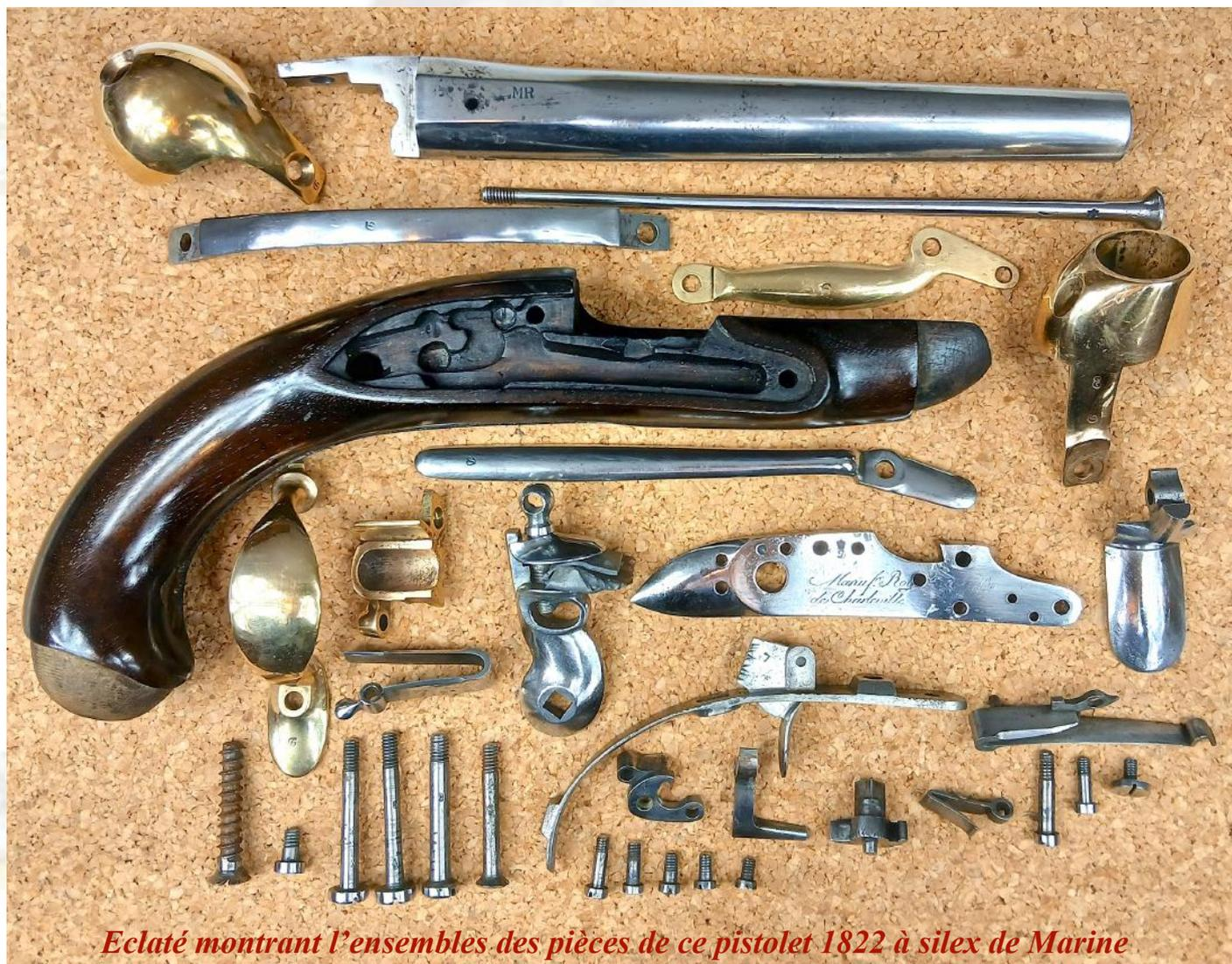
*Eclaté montrant l'ensemble des pièces de ce pistolet 1822 à silex de Marine*
